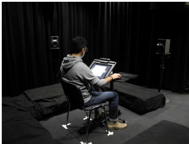
Abbildung 1 Der Versuchsaufbau im AuraLab: Der Proband befindet sich an zentraler Hörposition. Stimuli wurden über fünf Satellitenlautsprecher und zwei Subwoofer wiedergegeben.
